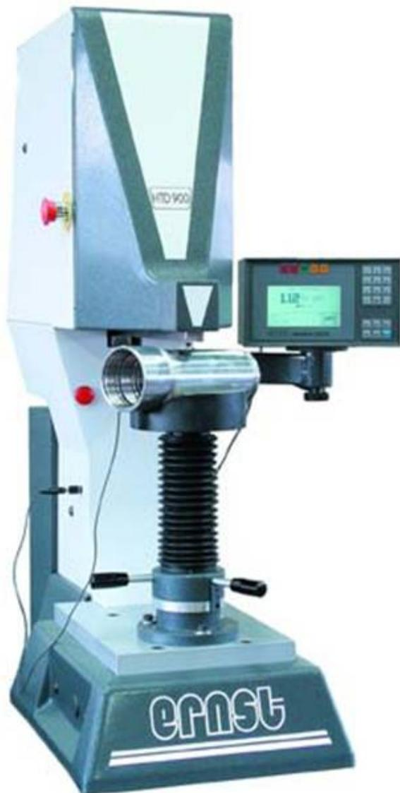
В основе работы твердомера HTD-900 лежит новейшая, запатентованная компанией ERNST SA технология измерения твердости ESATEST, которая позволяет измерять твердость не только на поверхности исследуемого объекта, а так же проводить анализ изменения твердости по глубине от поверхности объекта.
